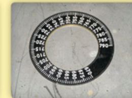
Ra-226 sisaldav mõõteriista näidik.
